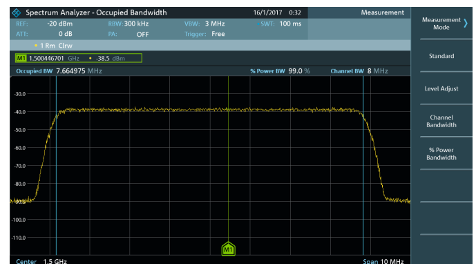
Опция R&S®FPC-K55: измерение занимаемой полосы частот.
