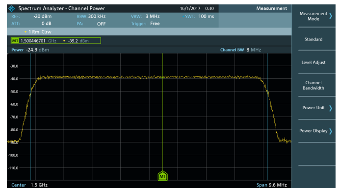
Опция R&S®FPC-K55: измерение мощности в канале.
